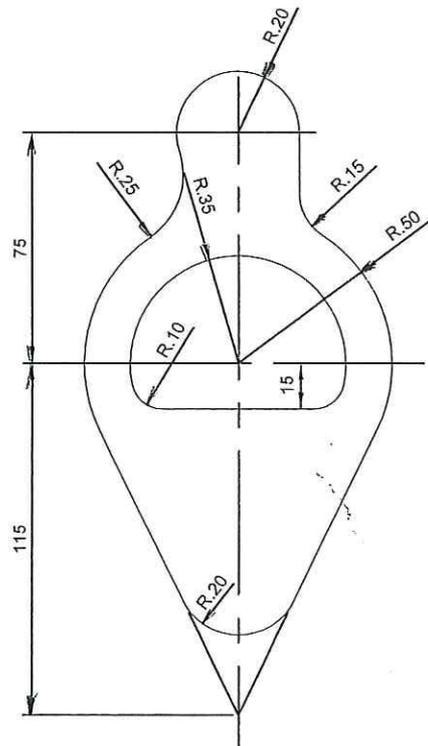
*1- Realiza el croquis acotado a mano alzada y posteriormente un dibujo a escala 3:1 de la pieza propuesta (sujetacables). Ambos dibujos a lápiz. Duración máxima 75 minutos.*
