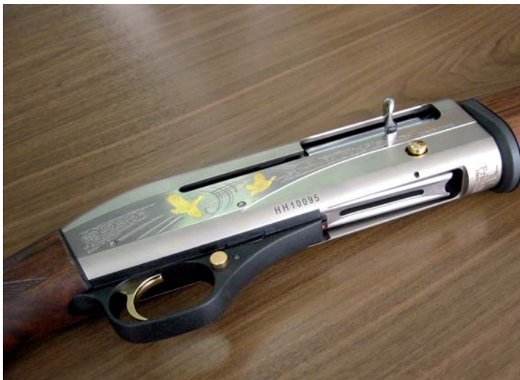
Sistema expulsor de una escopeta semiautomática.
