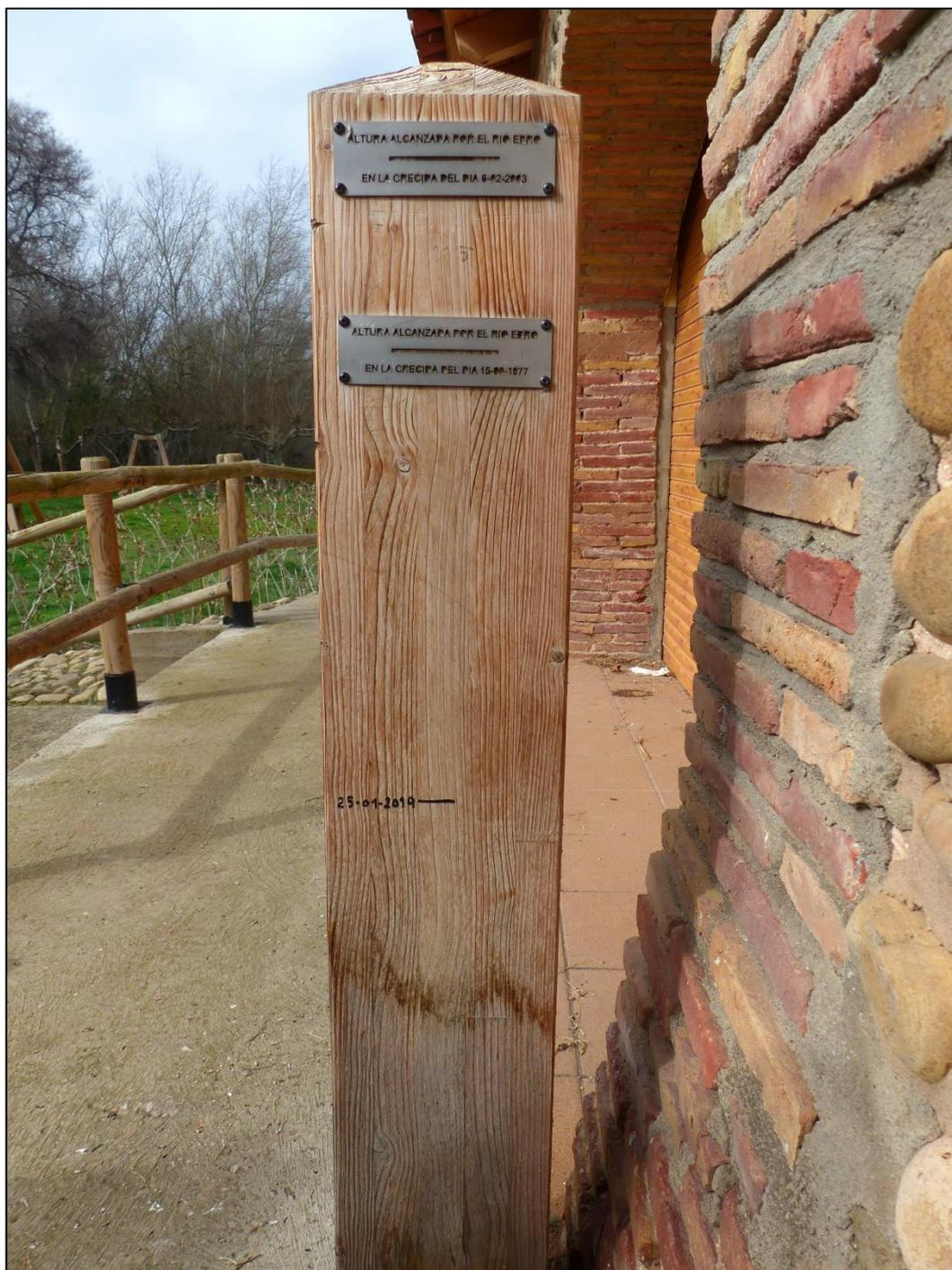
**Ilustración 44.** Poste colocado muy cerca del propio edificio, para señalar la altura alcanzada por el Ebro en inundaciones anteriores. Como se observa, tres avenidas anteriores se han marcado en el poste. La más importante tuvo lugar el 6 de febrero de 2003. La segunda en importancia fue la de junio de 1977. Respecto a los últimos años, la ocurrida a inicios de 2019 también se ha marcado como destacada en el poste (rotulador negro).
