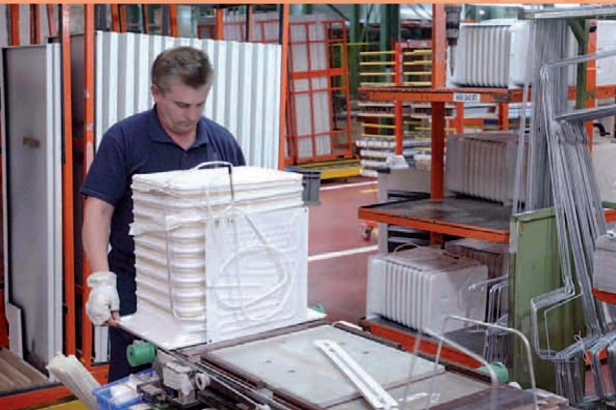
**Premontaje de un frigorífico en la planta de Esquíroz.**
