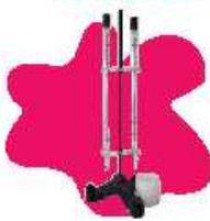
Este instrumento permite registrar de forma continua la temperatura y la humedad del aire en unas bandas de papel.
