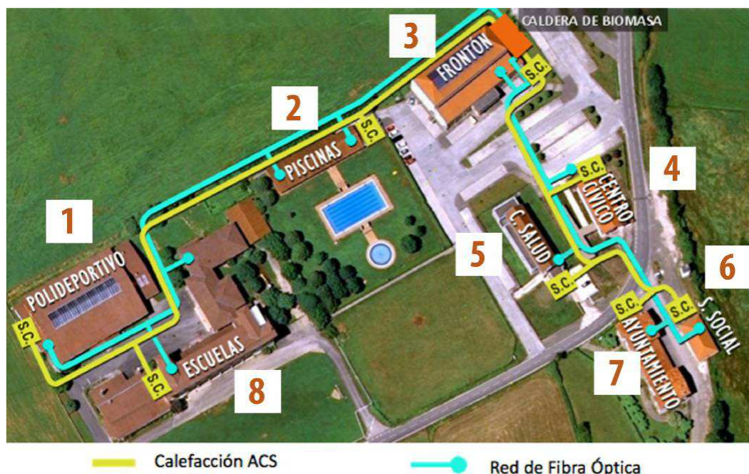
Imagen 5. Esquema de la red de calor municipal de Larrainzar (Ultzama)
