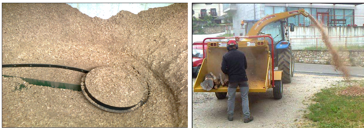
Imagen 27. Astilladora y alimentador de astillas en silo.
