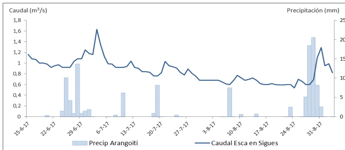
**Gráfico 3. Caudales medios diarios en m<sup>3</sup>/s en la estación de aforo de Esca en Sigüés (CHE) y precipitación acumulada diaria en l/m<sup>2</sup> en la estación meteorológica de Arangoiti entre el 15-06-2017 y el 03-09-2017 (temporada "corta"). Fuente de datos: Web del Agua de Navarra, Mete Navarra y CHE. Elaboración propia. Los datos son provisionales y están sujetos a revisión.**
