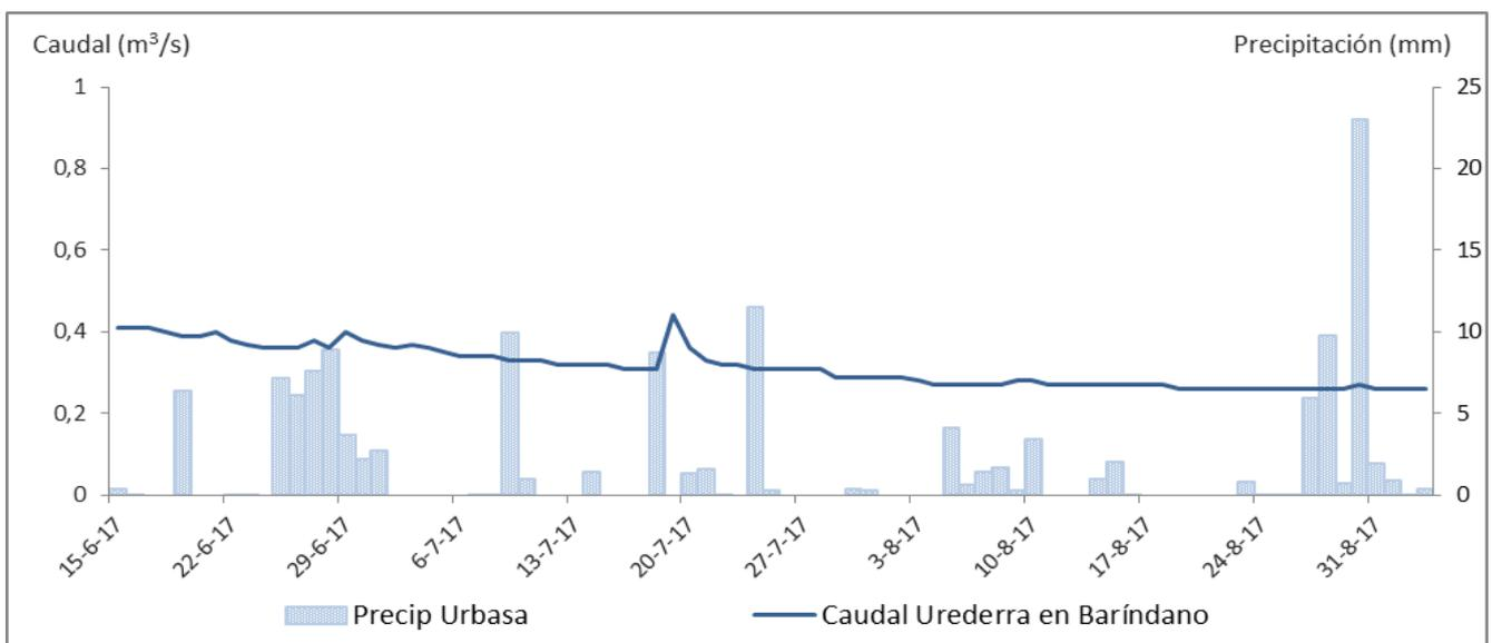
Gráfico 6. Caudales medios diarios en m<sup>3</sup>/s en la estación de aforo de Urederra en Barindano y precipitación acumulada diaria en l/m<sup>2</sup> en la estación meteorológica de Urbasa entre el 15-06-2017 y el 03-09-2017 (temporada “corta”). Fuente de datos: Web del Agua de Navarra y MeteoNavarra. Elaboración propia. Los datos son provisionales y están sujetos a revisión.
