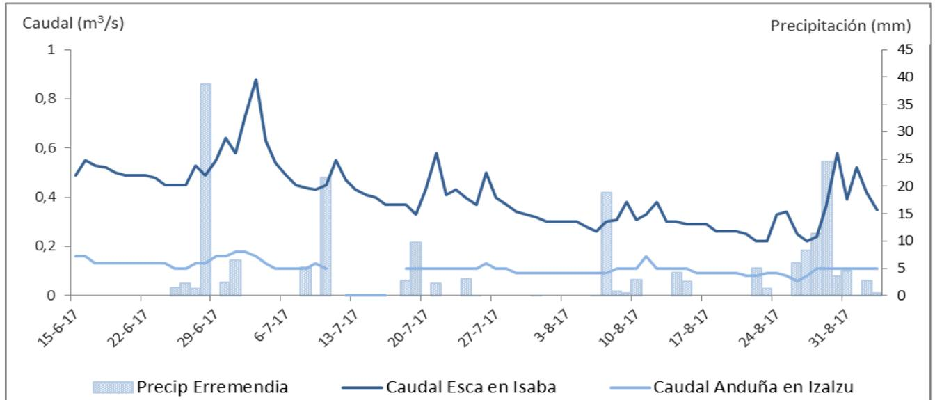
Gráfico 4. Caudales medios diarios en m<sup>3</sup>/s en las estaciones de aforo de Anduña en Izalzu (CHE) y Esca en Isaba (CHE), y precipitación acumulada diaria en l/m<sup>2</sup> en la estación meteorológica de Erremendia entre el 15-06-2017 y el 03-09-2017 (temporada "corta"). Fuente de datos: Web del Agua de Navarra, MeteoNavarra y CHE. Elaboración propia. Los datos son provisionales y están sujetos a revisión.
