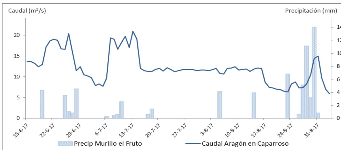
**Gráfico 2. Caudales medios diarios en m<sup>3</sup>/s en la estación de aforo de Aragón en Caparroso (CHE) y precipitación acumulada diaria en l/m<sup>2</sup> en la estación meteorológica de Murillo el Fruto entre el 15-06-2017 y el 03-09-2017 (temporada “corta”). Fuente de datos: Web del Agua de Navarra, MeteoNavarra y CHE. Elaboración propia. Los datos son provisionales y están sujetos a revisión.**
