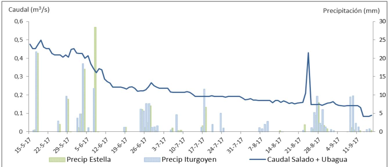
Gráfico 5. Sumatorio de caudales medios diarios en m<sup>3</sup>/s en la estación de aforo de Ubagua en Riezu (CHE) y en la estación de aforos del río Salado en Estenzoz (CHE) y precipitación acumulada diaria en l/m<sup>2</sup> en las estaciones meteorológicas de Estella y Trinidad de Iturgoien entre el 15-05-2017 y el 17-09-2017 (temporada “larga”). Fuente de datos: Web del Agua de Navarra, MeteoNavarra y CHE. Elaboración propia. Los datos son provisionales y están sujetos a revisión.
