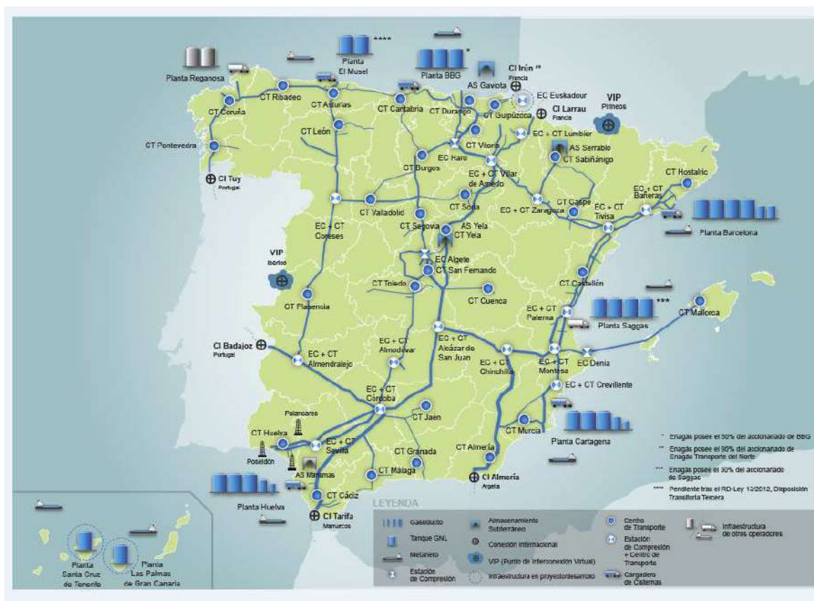
Figura 5.3 Red de transporte de gas
