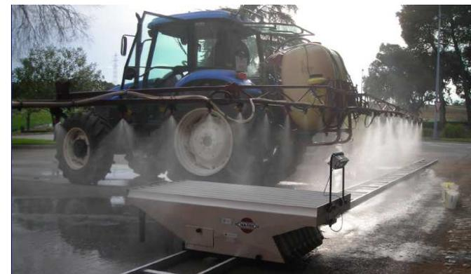
Para comprobar el correcto estado y funcionamiento de los equipos se deben realizar inspecciones periódicas, donde se constata visualmente el estado de la máquina y se realizan diversas mediciones (caudal de las boquillas, contrastación del manómetro, lectura de presiones...).
