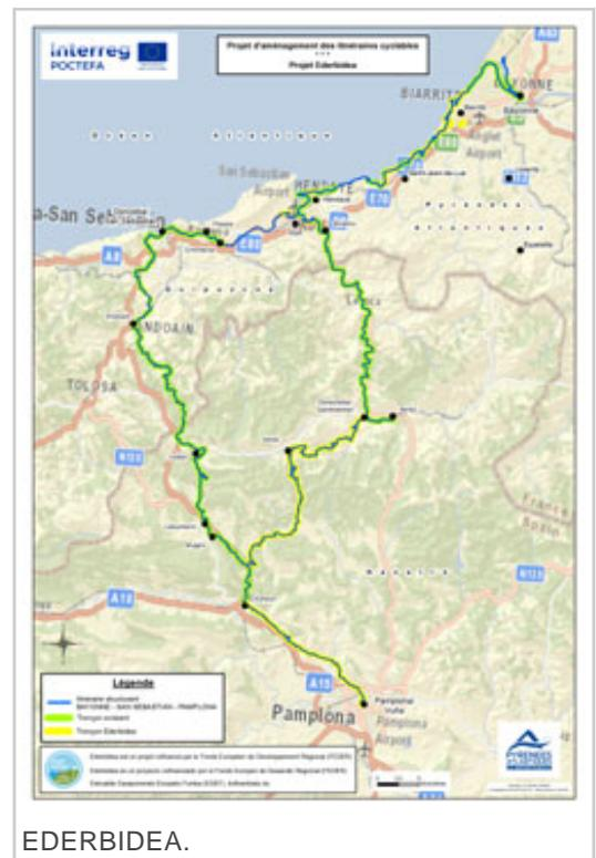
trazado cuenta con pendientes longitudinales de más del 6% en más de un 12% del trazado, y de hasta el 22% en algunos tramos.
