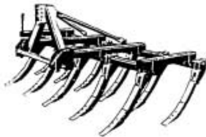
FIG. 85 Cultivador pesado "chisel" de dientes rígidos, suspendido.
