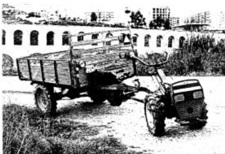
FIG. 65 Motocultoras con remolque de eje motor.
