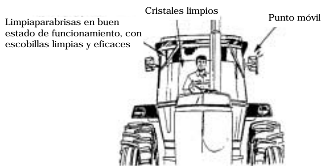
FIG. 30 La buena visibilidad depende de la limpieza de los cristales, de un limpiaparabrisas en buen estado de funcionamiento y de un limpiador de cristales con agua*
