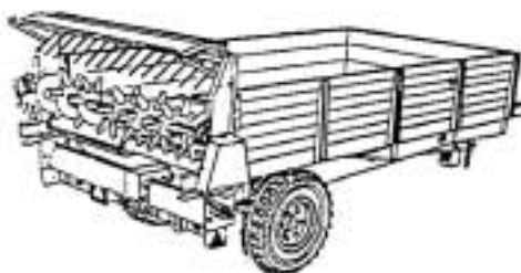
FIG. 90 Remolque distribuidor de estiércol (de rotación horizontal).
