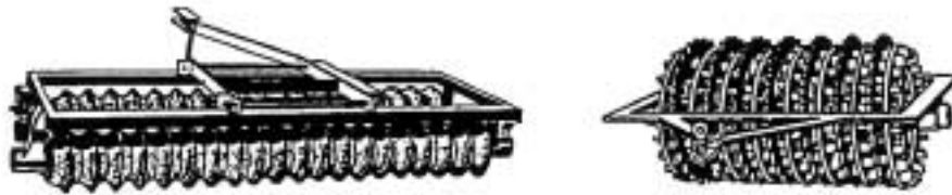
a) Rodillo trazador o rodillo "cultipacker", remolcado b) rodillo "croskill, remolcado
