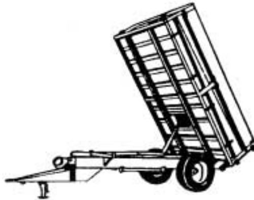
FIG. 132 remolque de báscula triple (en la posición de báscula hacia atrás).
