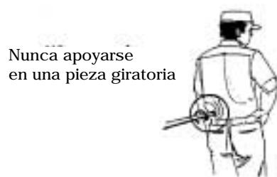
FIG. 5 Cuidado con las extremidades de los ejes que no están protegidos*.
