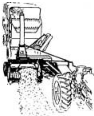
FIG. 125 Ensiladora-picadora-cargadora de forrajes polivalente en la versión "pick up".
