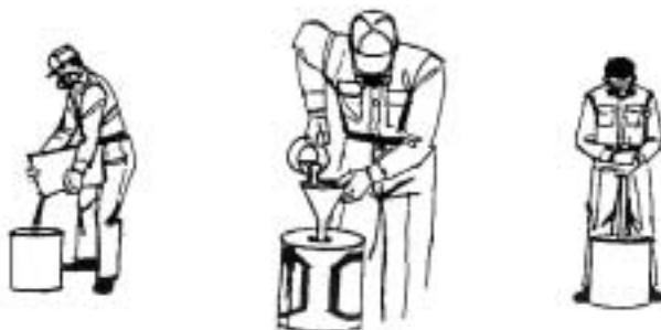
FIG. 108 Riesgo de inhalación durante la preparación.
