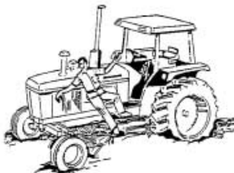
FIG. 25 Mantener los estribos limpios: de barro, nieve, grasas, etc.*.
