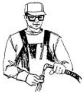
FIG. 110 Desobstrucción de las bocas con aire comprimido*.
