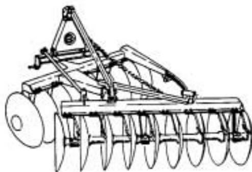
FIG. 81 Grada de disco tipo "offset", con abertura y cierre automáticos, dos cuerpos suspendida.
