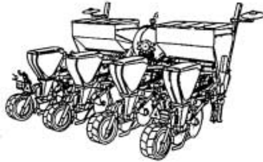
FIG. 95 Sembradora monograno, neumática (de 4 líneas)
