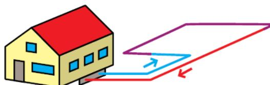
Ilustración 9 Sistema cerrado horizontal en disposición bucle único en zanja.
