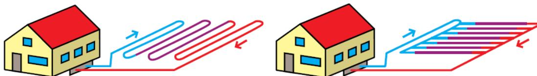
Ilustración 8 Sistema cerrado horizontal en disposición serie a) y paralelo b).
