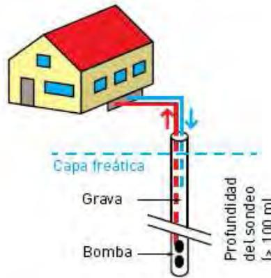
Ilustración 16 Pozo tipo columna.
