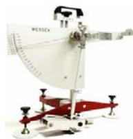
Las medidas se realizarán tal como establece el Código Técnico de la Edificación por el método de ensayo del péndulo descrito en la Norma UNE-EN 12633:2003.
