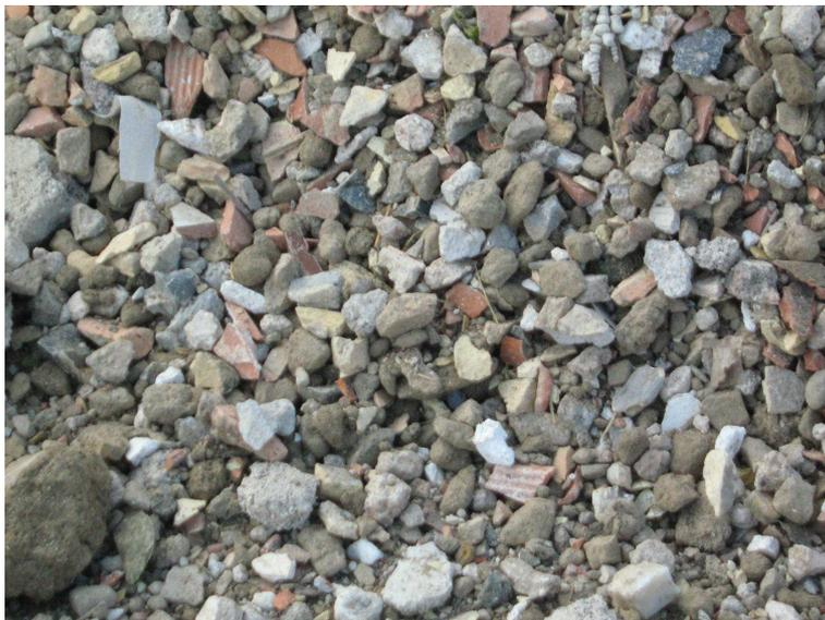
**Residuos de construcción y demolición ya tratados en planta**
